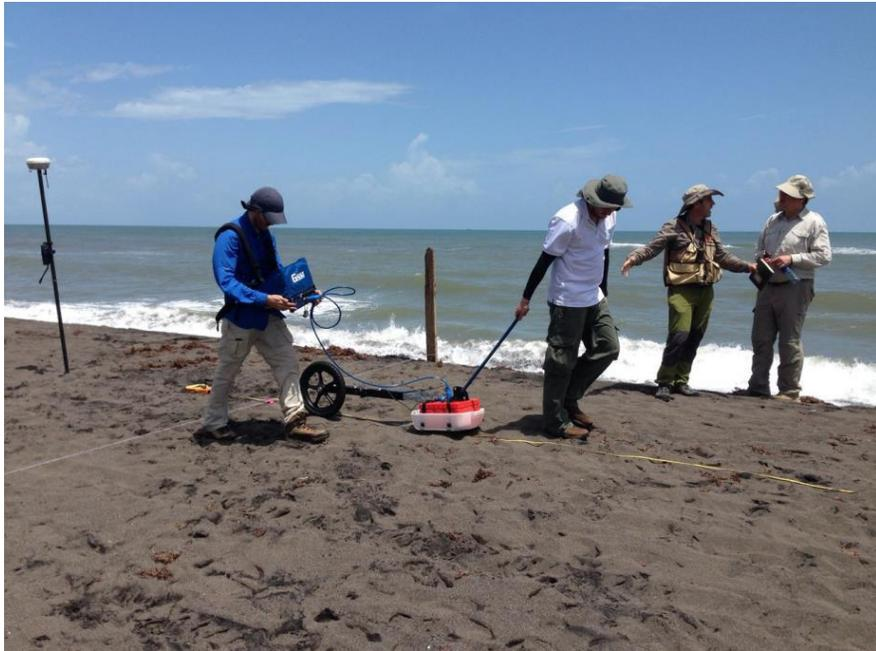
**Figura** Proceso de toma de lecturas mediante el radar de penetración terrestre (imagen facilitada por don Arnoldo Brenes).
